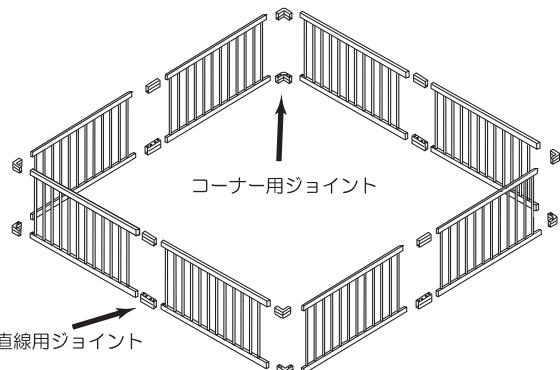
ベースパネルのプッシュボタンを押しながら、コーナー用ジョイントまたは直線用ジョイントを差し込み、プッシュボタンの頭がジョイントの穴から出ているかを確認しながら、組み立ててください。
