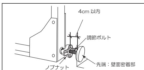
**注意** 取り付けたとき調節ボルトの長さが4cm以内になるように取り付けてください。
