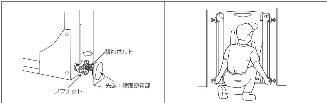
④取り付ける場所にゲートをセットして、下側の調節ボルトを締め付けた後、上側を締め付けてください。
