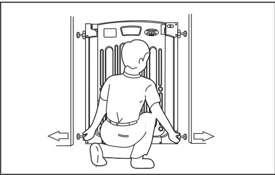
④取り付ける場所にゲートをセットして、下側の調節ボルトを締め付けた後、上側を締め付けてください。
