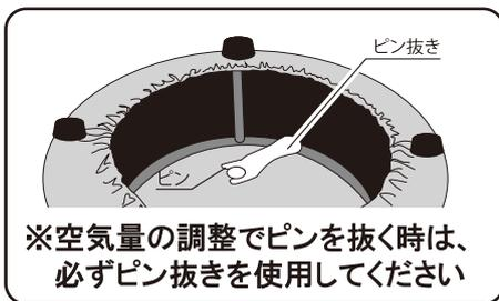
※空気量の調整でピンを抜く時は、必ずピン抜きを使用してください
