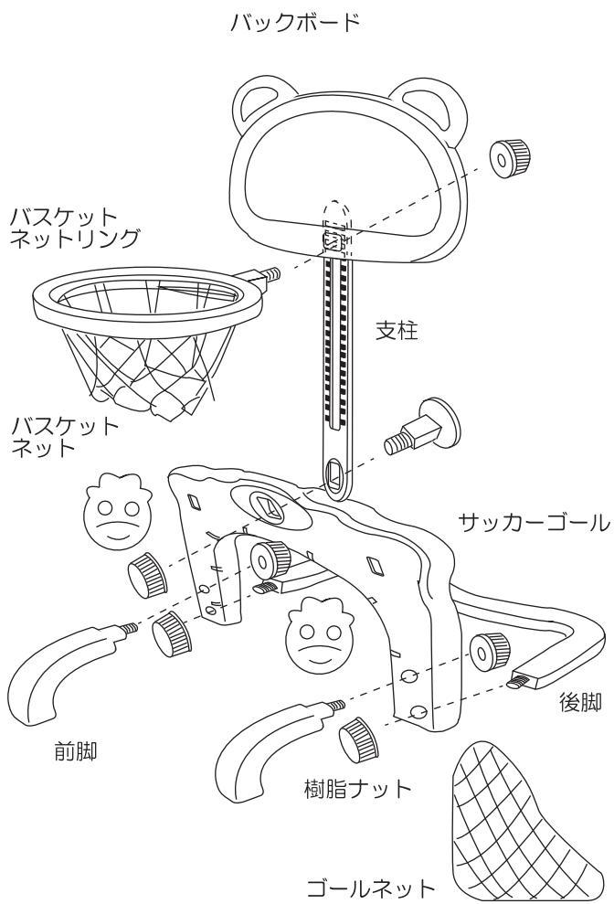
1. サッカーゴールに前脚2個と後脚を差し込み樹脂ナットで固定してください。
