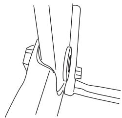
3. バスケットリングを支柱に差し込みバックボードと一緒に固定してください。
